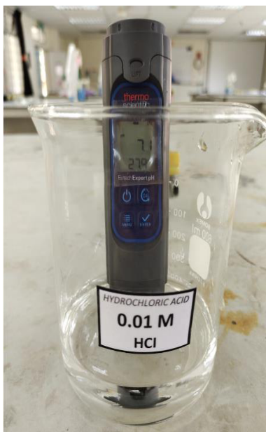
GAMBAR 1 : Kaedah mengukur pH menggunakan pH meter di makmal.
