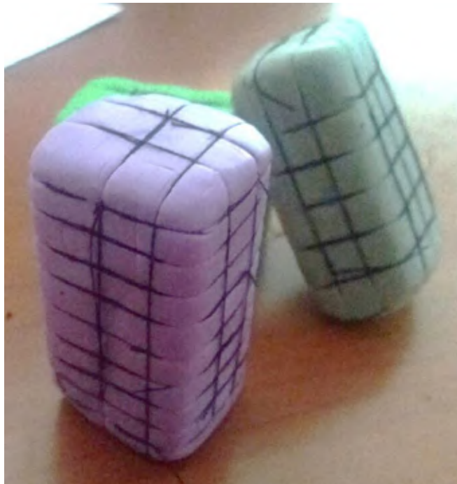
Rajah 6.2 Bentuk plastisin segi empat tepat yang telah siap dililit benang mengikut garisan grid terkawal
