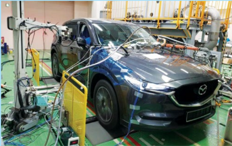
Rajah 4. Kenderaan uji kaji berteknologi Euro 5 menggunakan biodiesel sawit di makmal Institut Penyelidikan Automotif (JARI), Jepun.
