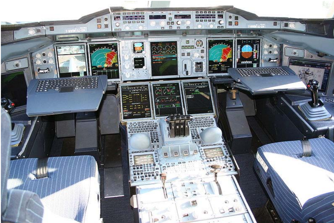
EFIS on an Airbus A380
