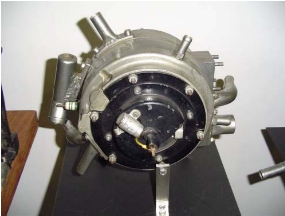
First KKM Wankel Engine NSU KKM 57P ( Kreiskolbenmotor ), at Autovision und Forum, Germany
