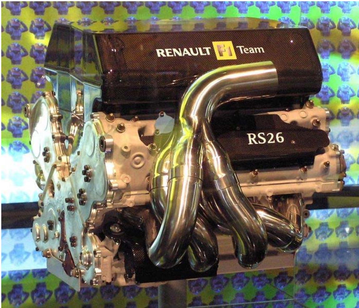
Renault F1 RS26 (2006), 2,398cc V8 engine
