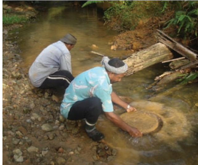
Eksplorasi geokimia : mendulang bagi mendapatkan konsentrat mineral berat ( heavy mineral concentrates )
