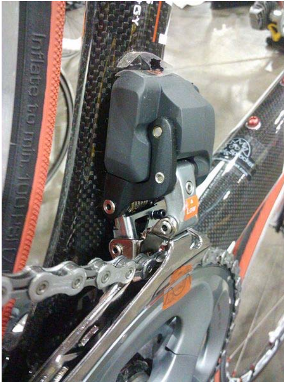
Electrically actuated front derailleur
