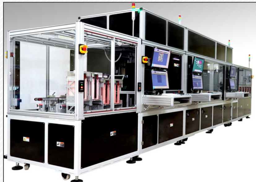
7.1 Mesin pemeriksaan kualiti wafer solar.
