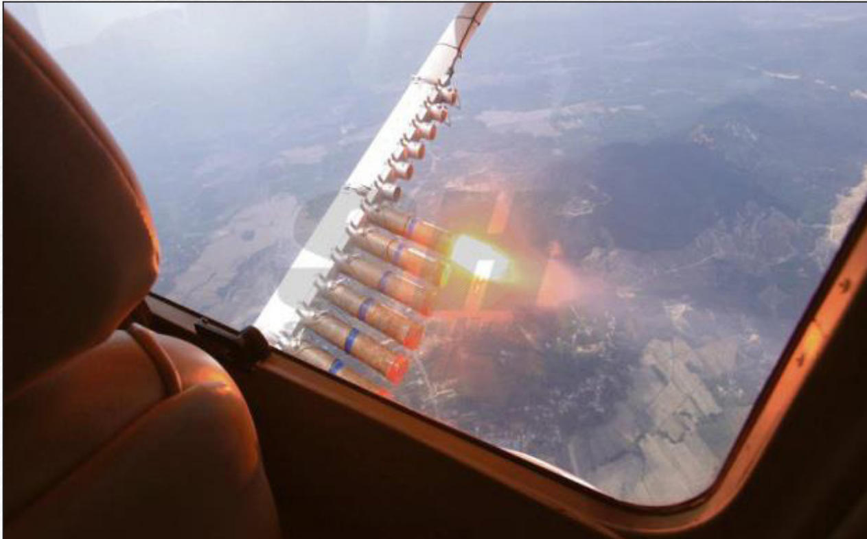
37.5 Proses pembakaran flare untuk kaedah pembenihan kering OPA.
