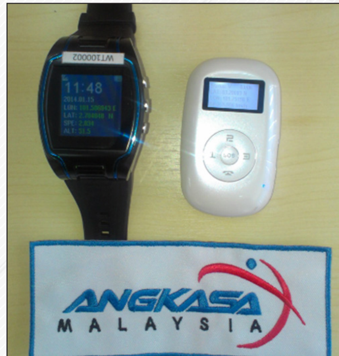
28.4 Pengesanan peranti kedudukan GPS ( GPS Locator ) yang digunakan untuk REMS.
