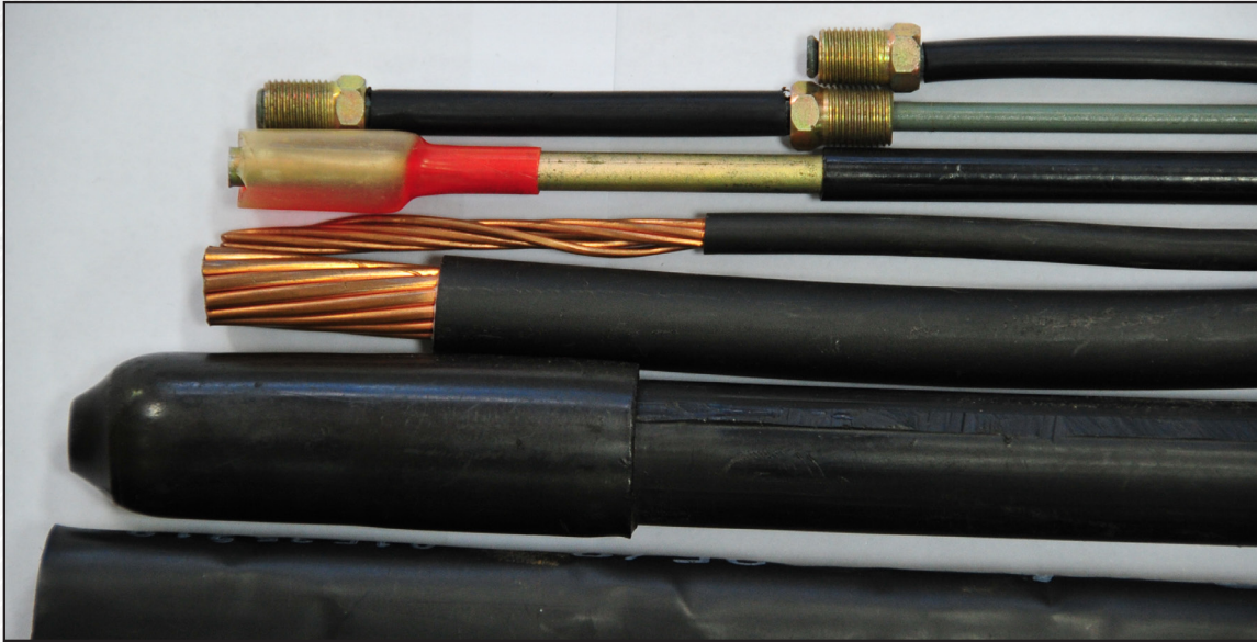
6.2 Produk kabel yang telah melalui proses taut silang EB.
