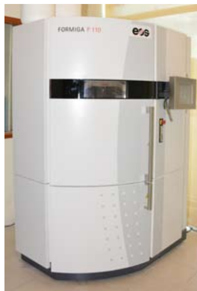
SLS P110: Mesin ini boleh menghasilkan prototaip berfungsi yang sesuai untuk komponen tahan lasak dan tahan suhu tinggi
