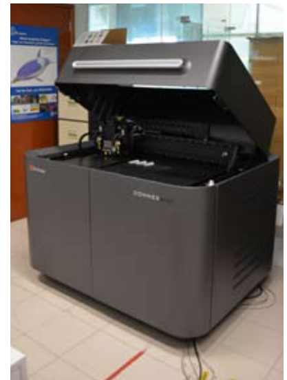
Connex 350: Mesin ini mengeluarkan prototaip yang berfungsi. Bahagian aplikasi yang biasa adalah selitan dai dan acuan dan prototaip atas acuan
