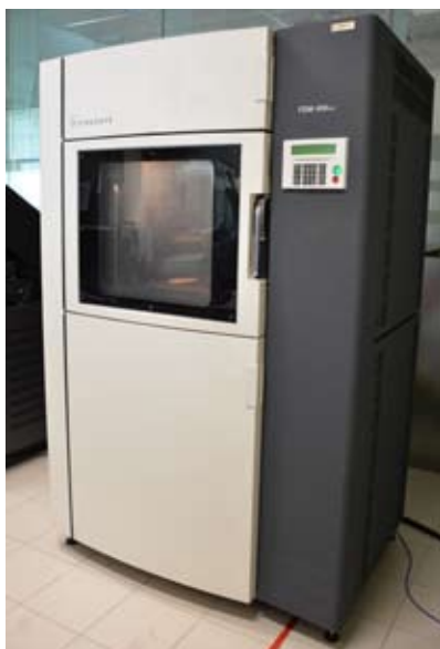
FDM 400MC: Komponen yang dihasilkan adalah untuk bentuk dan pemasangan, ilustrasi produk dan corak induk
