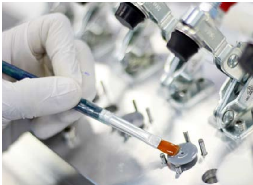
Proses melekatkan glu ke atas peranti penyingkir udara buatan Steripack untuk pembedahan kardioraks
